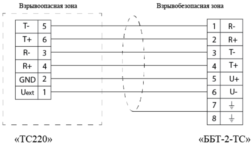
Рисунок 5. Схема подключения блока к корректору «ТС220».
